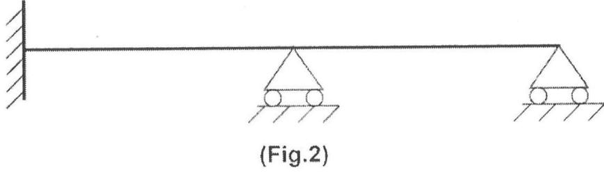
6. ذیل میں دئے گئے Fixed Beam کا SFD اور BMD معلوم کیجئے۔ Elastic Curve پر Point of Contra Flexure کی
